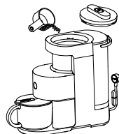
④ 根据食谱用量，将食材加入搅拌杯并旋紧搅拌杯盖组件
